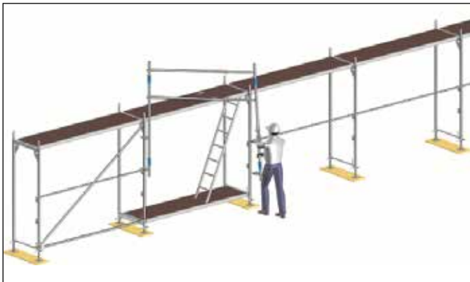
Bild 24: Montering av montereräcke
