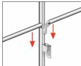
Bild 31: Montering av enkelräcke!
