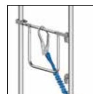
Bild 14: Fästpunkt 6.2 (OBS! EJ tillåtet på alu-SpeedyScaf).
