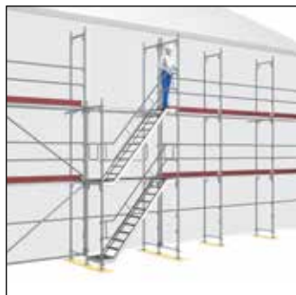
Bild 66: Montering av gavelrücke
