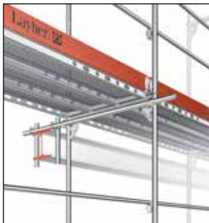
Bild 60: Förankring i horisontella stålbalkar
