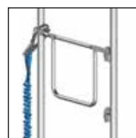
Bild 13: Fästpunkt 6.1 (OBS! EJ tillåtet på alu-SpeedyScaf).
