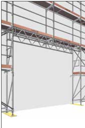
Bild 97: Överbryggnig med fackverksbalk
