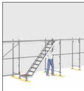
Bild 64: Montering av trappa
