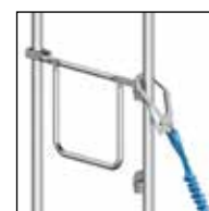
Bild 15: Fästpunkt 6.3 (OBS! EJ tillåtet på alu-SpeedyScaf).
