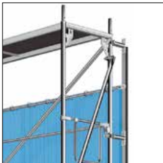
Bild 130: Utförande med ställningsduk
