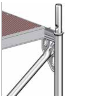
Bild 28: Diagonalstag monterat i ramens hörnplåt
