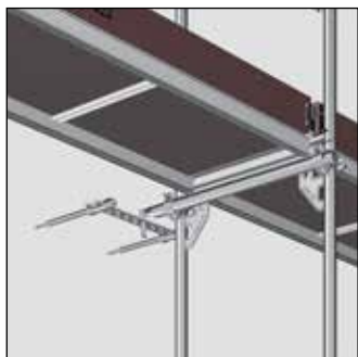
Bild 57: Förankring med ETICS-förankring
