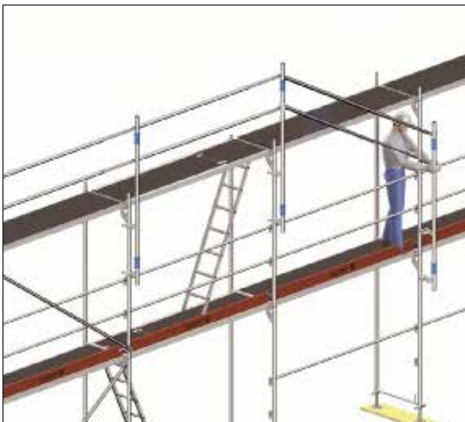
Bild 25: Detalj höjning av montereräcket
