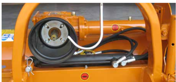
Kraftig transmission för 540 rpm. Hydraulisk sidoförskjutning finns som tillval.
