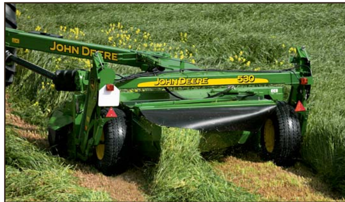
Genom att utrusta 500-serien med elektriskt manövrerade strängformningsplåtar kan man lägga strängarna sida vid sida . Det är ett kostnadseffektivt sätt att justera och gruppera materialflödet.
