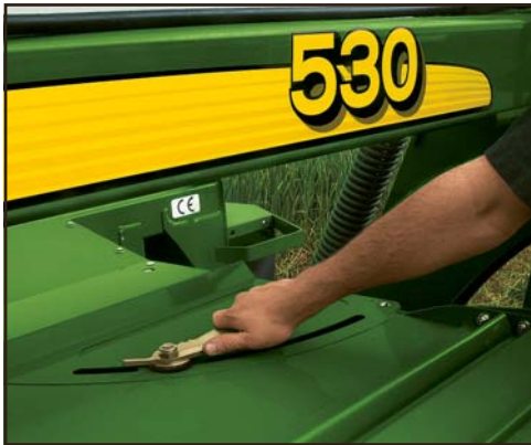
Strängformen justeras med den justerbara skärmen på stränglägggarplåten .
