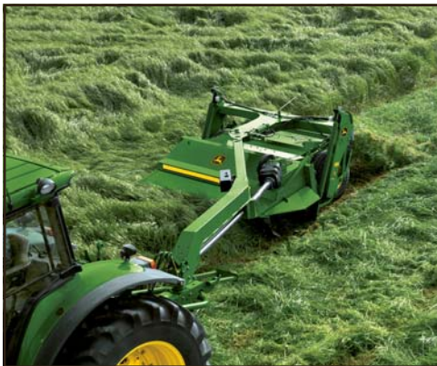
Dragbommens ledpunkt sitter nära huvudramens mitt och dess låga kopplingspunkt sänker tyngdpunkten på traktorn, vilket ger bättre stabilitet och spårföljning.
