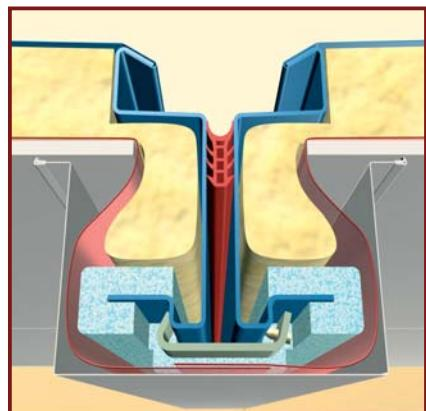
**DE:** Dachtunnel mit aufgesetzter Lippendichtung montieren. Eventuell verbleibende Fugen mit mitgeliefertem Silicon verschließen.
