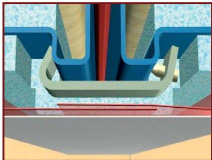
**DE:** Bereiche der Innenspannzangen im Styropor mit Messer freischneiden, die Dachlängsträger mit Innenspannzangen verschrauben. Die Dampfsperren (Folie) überlappend miteinander durchgehend mit Klebeband verkleben.
