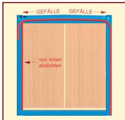
**DE:** Verlauf der Spezial-Gummidichtung bei Container 4 stirmseitig.
