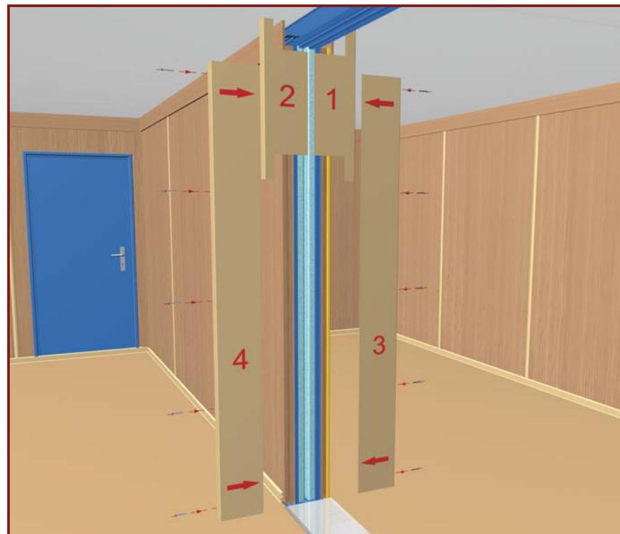
**FR:** 1.) Assemblage du couloir (version tôle) sans cloison intérieure: Introduire les morceaux de polystyrène entre les panneaux. Monter les parties en tôle équipées de profils en PVC dans l'ordre indiqué.
