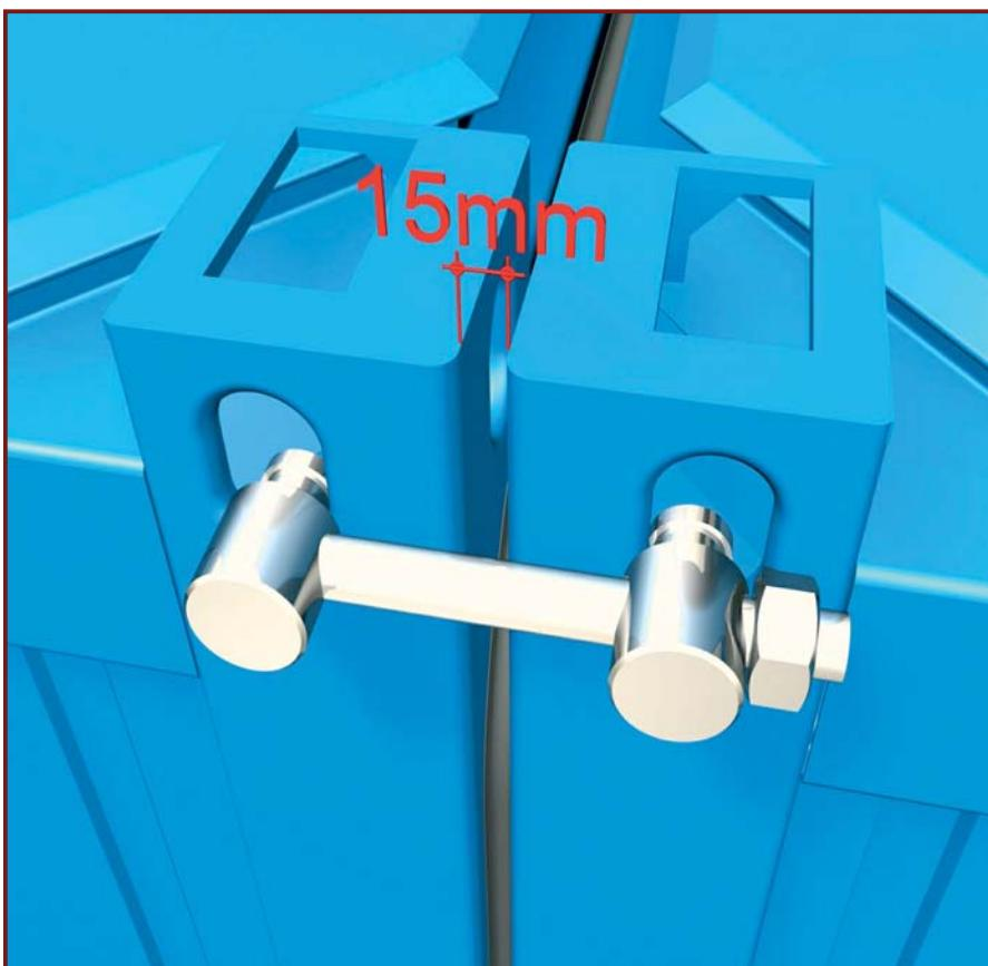
**DE:** Beide Container mit 4 Spannschrauben auf 15 mm zusammenziehen.
