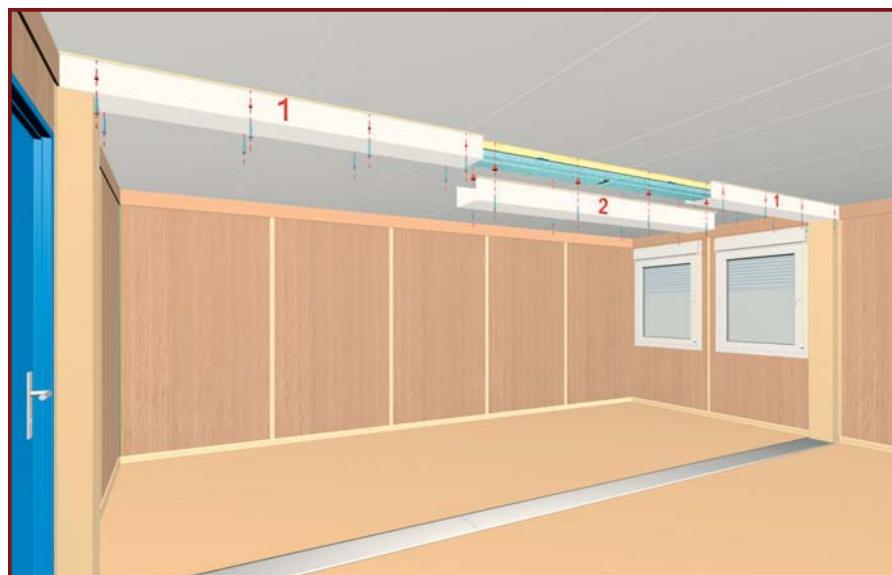
**HU:** Késsel vágjon lyukat a styroporhabon a szorítóelemeknél és csavarozza össze a kereszttartó idomokat. A szigetelőfólia széleit egymásra borítva ragassza össze szalagragasztóval.
