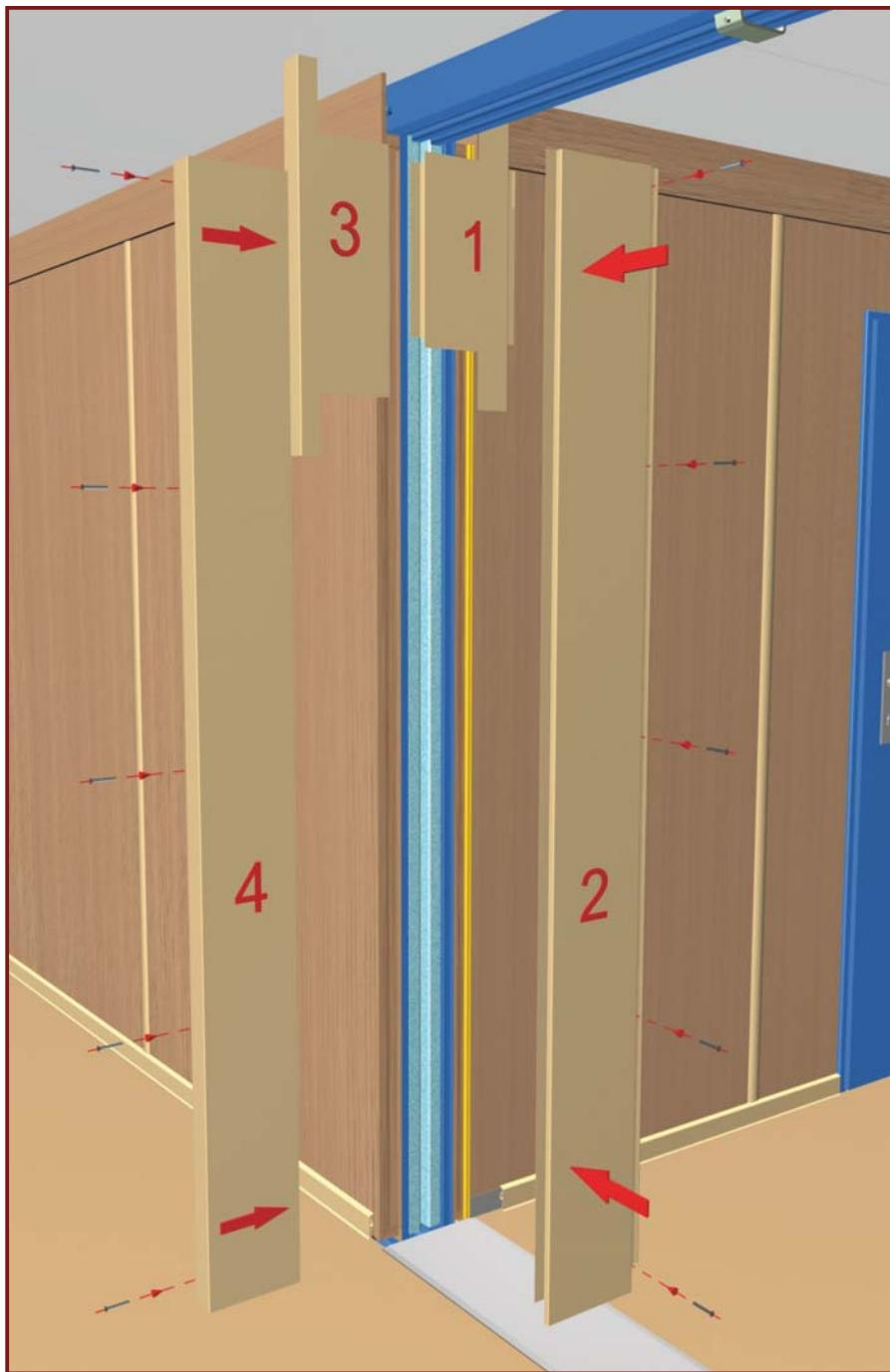
**DE:** 2.) Gangverbindung (Blech-Ausführung) mit einer Trennwand: Styroporsteile zwischen den Paneelen einsetzen. Blechteile mit aufgesetzten PVC-Profilen in der dargestellten Reihenfolge montieren.
