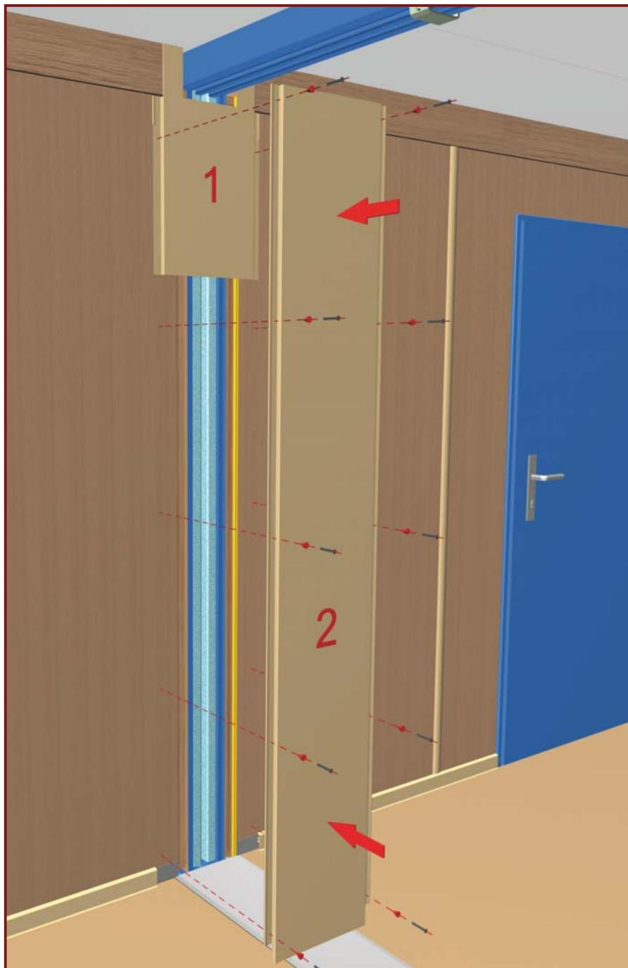
**DE:** 3.) Gangverbindung (Blech-Ausführung) mit zwei Trennwänden: Styroporteile zwischen den Paneelen einsetzen. Blechteile mit aufgesetzten PVC-Profilen in der dargestellten Reihenfolge montieren.
