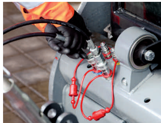
TransGiant är utrustad med lättåtkomliga hydraulanslutningar vid redskapsbyte.
