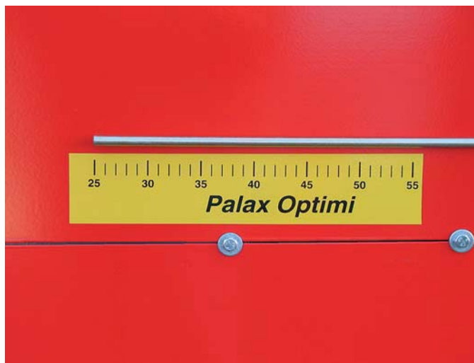
2. Slaglängdsoptimeringen kan ställas in för 25–55 cm långa kubbar.
