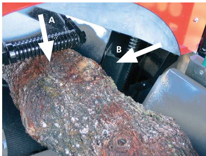
2. Då stocken kapas, låser sig först bakanslaget B på plats och därefter klämmer vedhållaren A stocken hydrauliskt mot bordet. Kapningen sker så fort stocken sitter ordentligt fast. Bakanslaget och vedhållaren håller även ett ojämnt och krokigt träd på plats under sågningen.
