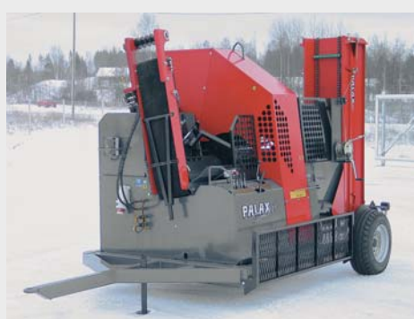
Egen transportunderride för bogsering med traktor
